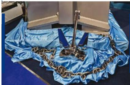
Posidonia è un'azienda che si è evoluta insieme al mondo della nautica e oggi progetta e produce ancore su misura fino a 20 tonnellate (quella in foto è da 1.440 kg), catene e materiale di coperta. Le ancore e il deck equipment vengono realizzati per lo più da lamiera saldata. I prodotti sono certificati dai maggiori registri come American Bureau of Shipping, Bureau Veritas, Det Norske Veritas, Lloyd's Register of Shipping, Rina, anche grazie a un banco prova cer-
