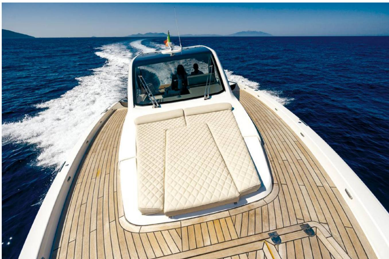
La prova in mare a Ostia rivela le doti di una carena che, anche se un po' sporca e quindi non al top della velocità, si dimostra stabile anche in virata stretta ad alti regimi.
